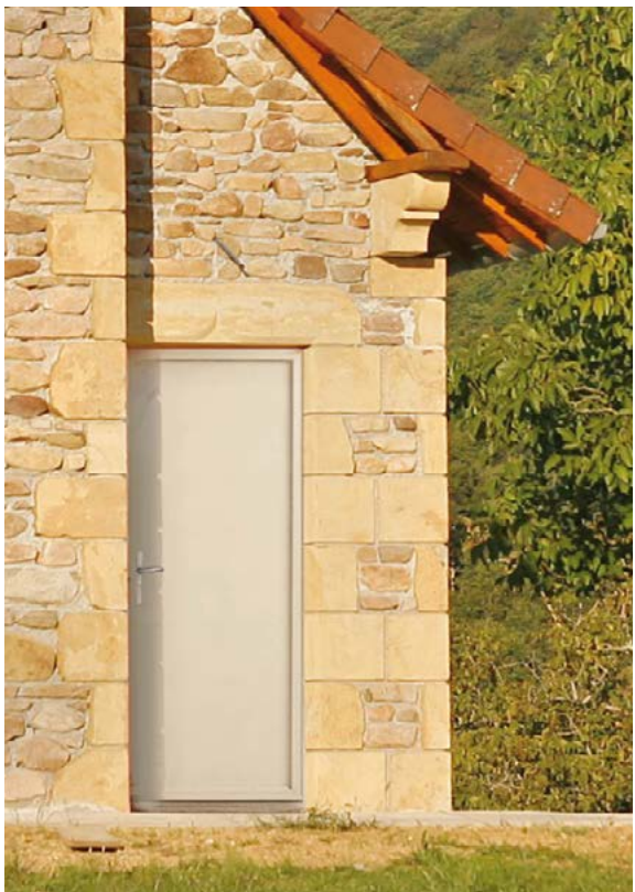
Porte de service non vitrée Isolation thermique : U_d = 1.4W / (m^2°C) Panneau : rainuré vertical Serrure : 5 points avec poignée contreplaqué
