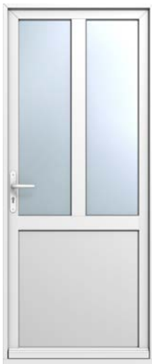
Creative classique 2 Isolation thermique : Ud <1,7 Motif : 1 traverse bois de 90 mm Vitrage : 4 Therm+ / 20 argon IC / 4 de base
