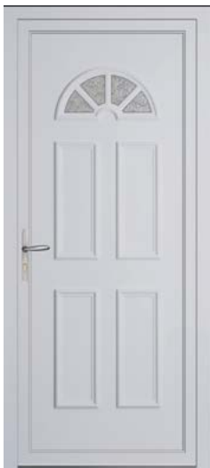
Éco Bulle Isolation thermique : U_d = 1.2W / (m^2°C) Motif : identique intérieur/extérieur Panneau : épaisseur 24 mm Vitrage : 33.2 Chinchilla clair avec petits bois thermoformés
