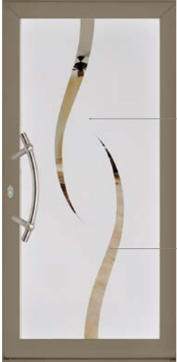
Gamma Isolation thermique : Ud = 1.2 W / (m2°C) en PVC Ud = 1.6 W / (m2°C) en aluminium Motif : identique intérieur/extérieur Vitrage : securit SP10 épaisseur 31 mm
