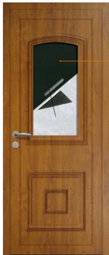
Bagatelle Isolation thermique : Ud = 1.2W / (m2°C) Motif : identique intérieur/extérieur Panneau parclosé : épaisseur 32 mm Choix du décor en pages 70 et 71
