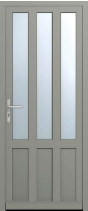
Indus 2 Isolation thermique : Ud <1,7 Motif : 1 traverse et 4 meneaux bois de 90 mm Vitrage : 4 Therm+ / 20 argon IC / 4 de base
