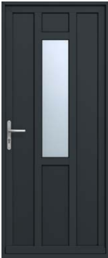
Creative Thiers 1 Isolation thermique : Ud <1,7 Motif : 2 traverses et 2 meneaux bois de 90 mm Vitrage : 4 Therm+ / 20 argon IC / 4 de base
