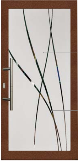
Beta Isolation thermique : Ud = 1.2 W / (m2°C) en PVC Ud = 1.6 W / (m2°C) en aluminium Motif : identique intérieur/extérieur Vitrage : securit SP10 épaisseur 31 mm
