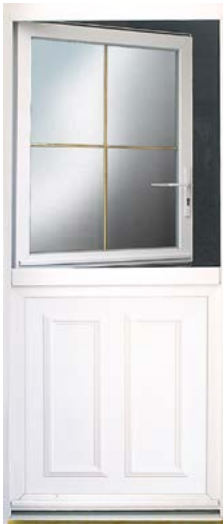
Fermière Isolation thermique : Ud = 1.4W / (m2°C) Panneau : mousse avec moulure Vitrage : 44.2 [classe 2] Serrure à relevage
