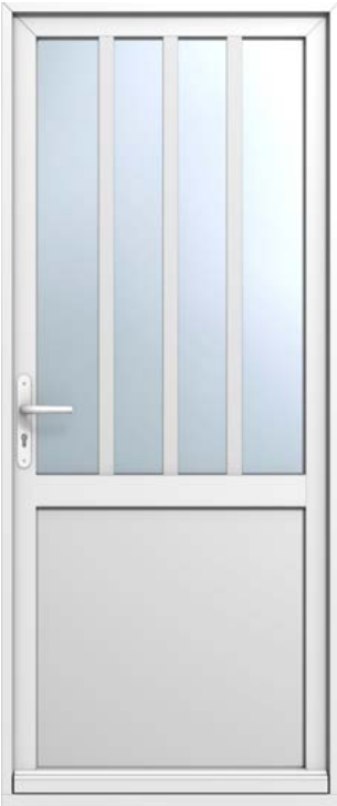
Indus 1 Isolation thermique : Ud <1,7 Motif : 1 traverse bois de 90 mm et 3 petits bois collés Vitrage : 4 Therm+ / 20 argon IC / 4 de base
