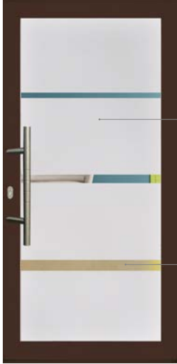
Kappi Isolation thermique : Ud = 1.2 W / (m2°C) en PVC Ud = 1.6 W / (m2°C) en aluminium Motif : identique intérieur/extérieur Vitrage : securit SP10 épaisseur 31 mm
