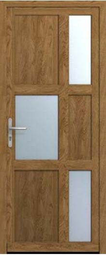
Graphik 2 Isolation thermique : Ud <1,7 Motif : 4 traverses et 1 meneau bois de 90 mm Vitrage : 4 Therm+ / 20 argon IC / 4 de base
