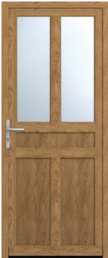
Creative classique 6 Isolation thermique : Ud <1,7 Motif : 2 traverses et 2 meneaux bois de 90 mm Vitrage : 4 Therm+ / 20 argon IC / 4 de base
