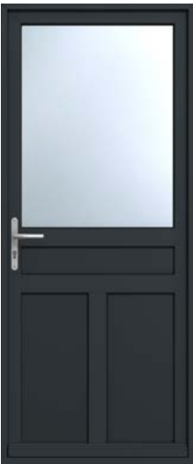
Creative classique 5 Isolation thermique : Ud <1,7 Motif : 2 traverses et 1 meneau bois de 90 mm Vitrage : 4 Therm+ / 20 argon IC / 4 de base
