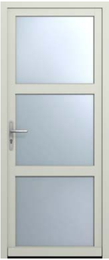
Longitude 2 Isolation thermique : Ud <1,7 Motif : 2 traverses bois de 90 mm Vitrage : 4 Therm+ / 20 argon IC / 4 de base
