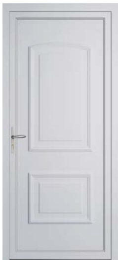
Éco Marine Isolation thermique : U_d = 1.2W / (m^2°C) Motif : identique intérieur/extérieur Panneau : épaisseur 24 mm
